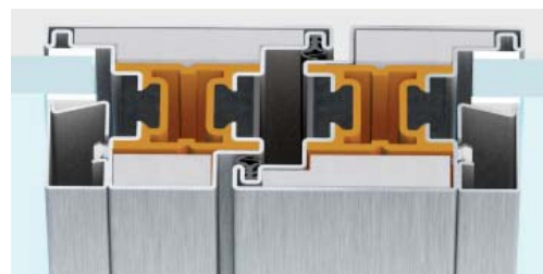
nodo centrale | sezione in vista 156 mm
