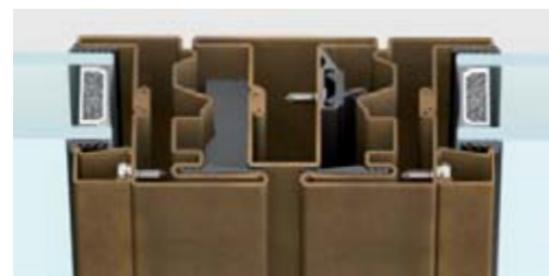
nodo centrale | sormonto | sezione in vista 145 mm
