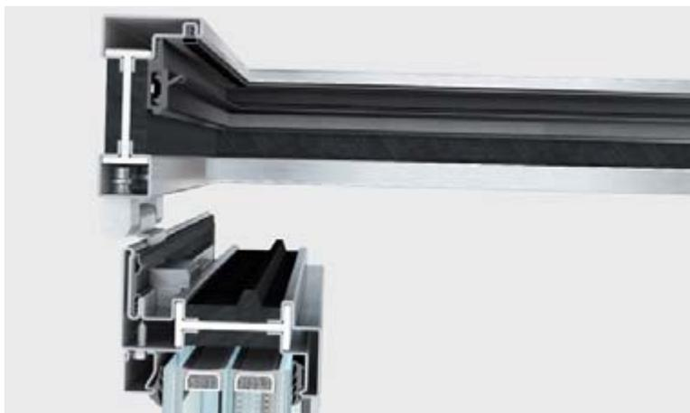
EBE 85 finestra è un sistema integrato di accessori, guarnizioni e profilati a taglio termico con profondità di 85 o 93,5 mm che consente di realizzare un'ampia gamma di finestre, rettangolari, sagomate o curve e di installare vetri a doppia camera fino a 68 mm di spessore. Ogni tipologia è provvista di apposita accessoristica (anche a scomparsa) integrata al sistema.
