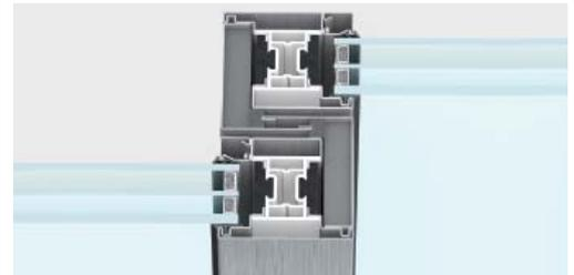
nodo centrale standard | sezione in vista 94 mm
