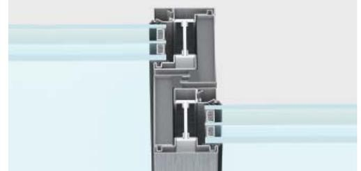
nodo centrale ridotto | sezione in vista 69 mm
