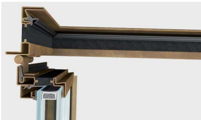
OS2 finestra apertura interna è un sistema integrato di accessori, guarnizioni e profilati a taglio termico con profondità di 64/65 mm che permette di realizzare un'ampia gamma di finestre, rettangolari, sagomate o curve. Si possono installare vetri camera fino a 40 mm di spessore. Ogni tipologia è provvista di apposita accessoristica integrata al sistema.
