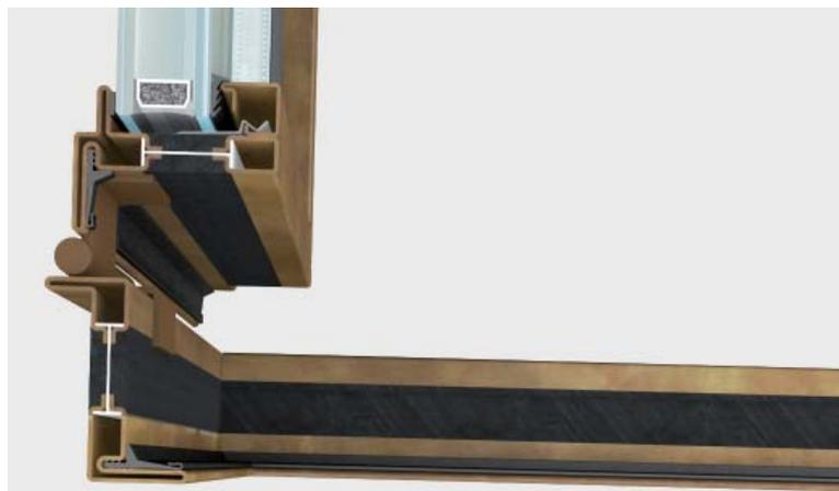
OS2 finestra apertura esterna è un sistema integrato di accessori, guarnizioni e profilati a taglio termico con profondità di 65 mm che permette di realizzare un'ampia gamma di finestre, rettangolari, sagomate o curve. Si possono installare vetri camera fino a 30 mm di spessore. Ogni tipologia è provvista di apposita accessoristica integrata al sistema.
